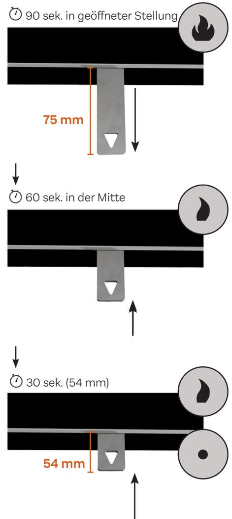
Der Dämpfer wird dann zwischen der Mittelstellung und der geschlossenen Stellung eingestellt.
