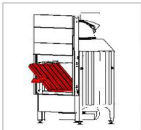
1. Entfernen Sie die seitliche Skamol-Platte.
