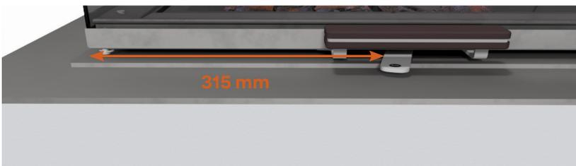
\*Die genaue Einstellung des Dämpfers zwischen Mittel- und Schließstellung beträgt 315 mm von der Türkante bis zur Kante des Dämpfergriffs.
